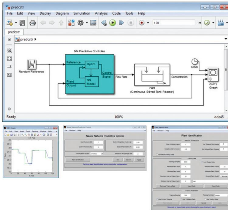
Модель Simulink, которая использует блок Neural Network Predictive Controller для управления реактором с механическим перемешиванием (сверху). Вы можете визуализировать динамические характеристики (внизу слева), управлять регулятором блока (внизу в центре) и идентификацией вашего объекта (внизу справа)
