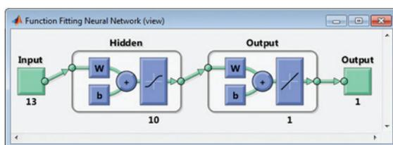
*Двухслойная сеть с прямой связью, скрытым слоем нейронов сигмоидального типа и линейными выходными нейронами. Этот тип сети может подходить для многомерных задач отображения, при задании согласованных данных и достаточном количестве нейронов в скрытом слое*
