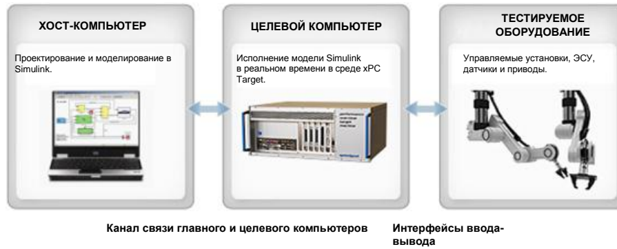
Компоненты среды тестирования в реальном времени xPC Target
